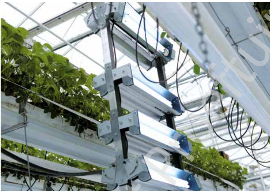
Het eerste prototype van de robot voor de aardbeienteelt is uitgerust met 8 UV-C-lampen van 160 W. De robot kan rijden aan 0,54; 0,9; 1,8 of 3,6 km/uur. Dat resulteert in een blootstelling van 20, 12, 6 of 3 MJ/cm² UV-C-licht.
