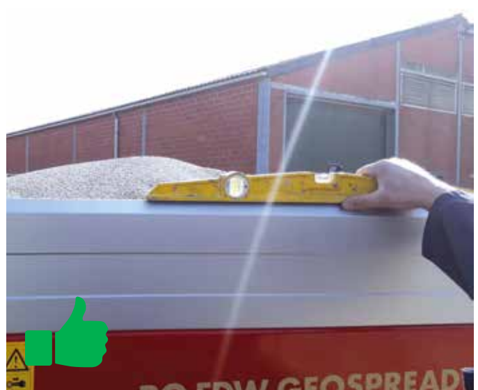
Een waterpas aan de strooier hangen is een goed idee.
